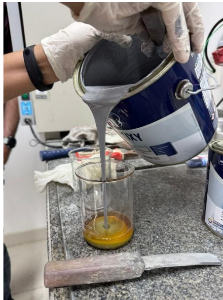
Figura 33: Preparação de tinta epóxi
