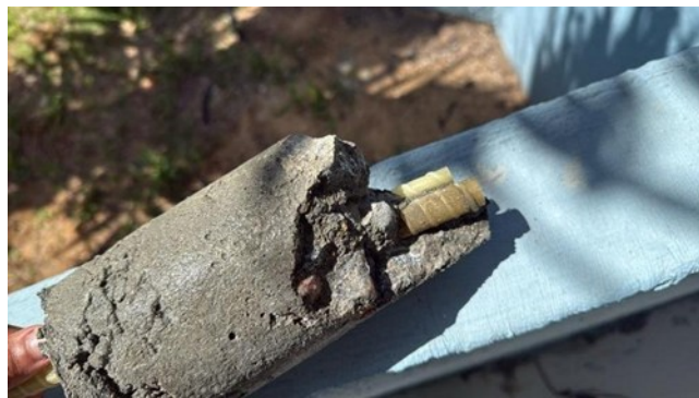
Figura 53: Quebra dos corpos de provas
