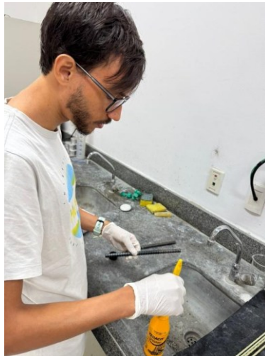
Figura 30: Preparando superfície para receber a pintura
