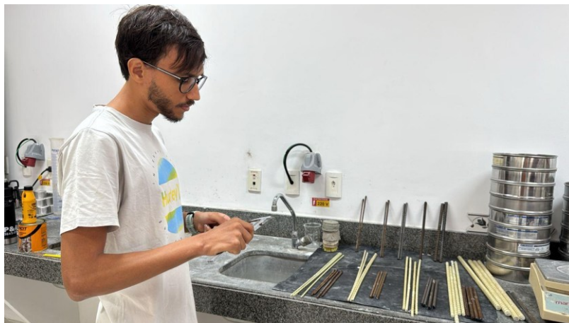
Figura 28: Medição de espessura dos vergalhões e barras
