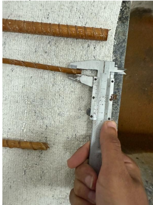
Figura 45: Medição da barra de fibra de vidro a 350 graus
