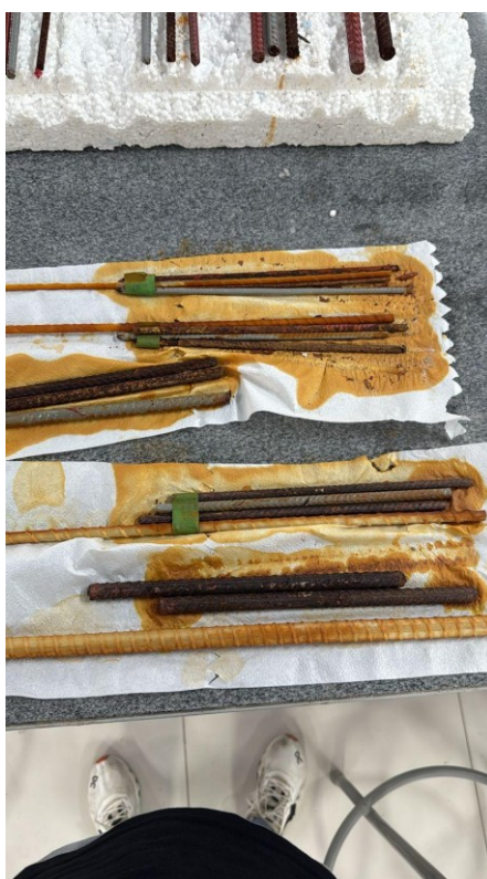
Figura 43: Medição das barras após submersão no ácido
