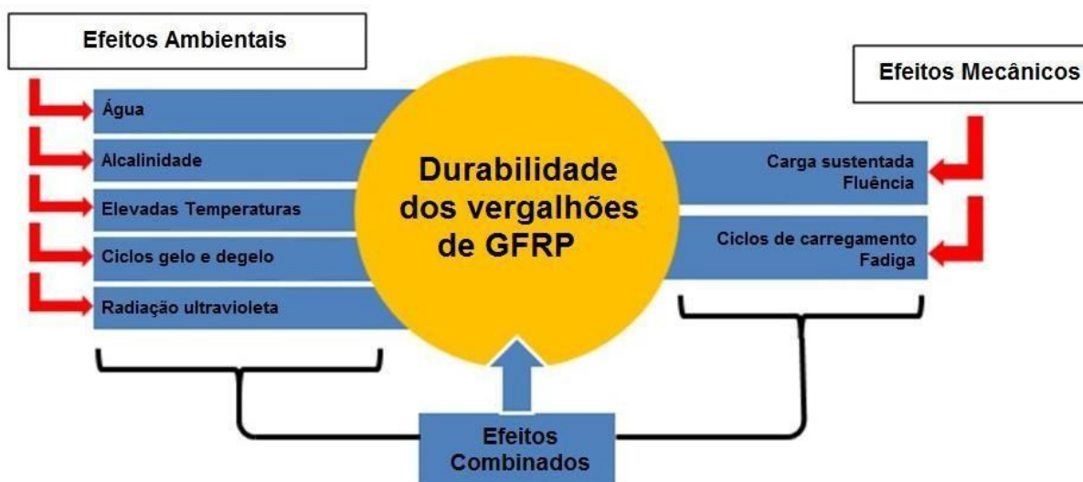
Figura 23. Fatores que podem interferir na durabilidade dos vergalhões de GFRP.
