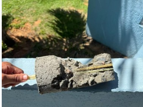
Figura 52: Quebra dos corpos de provas
