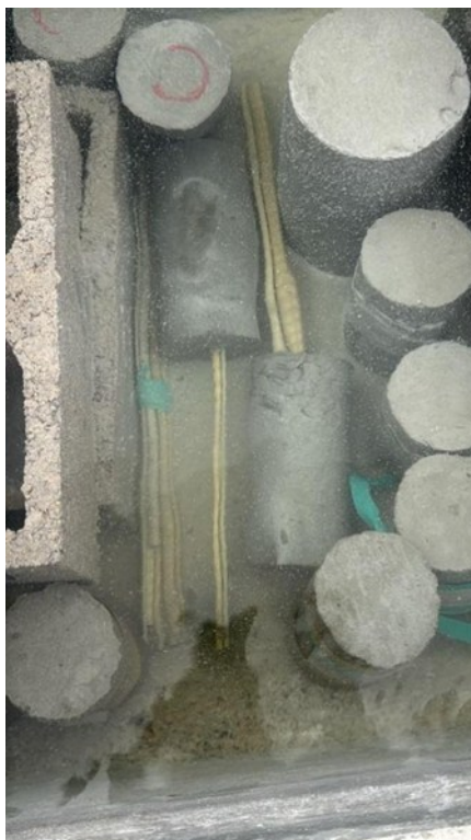
Figura 51: corpos de prova exposta a água
