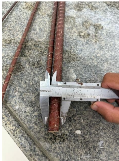
Figura 46: Medição da barra de fibra de vidro a 400 graus
