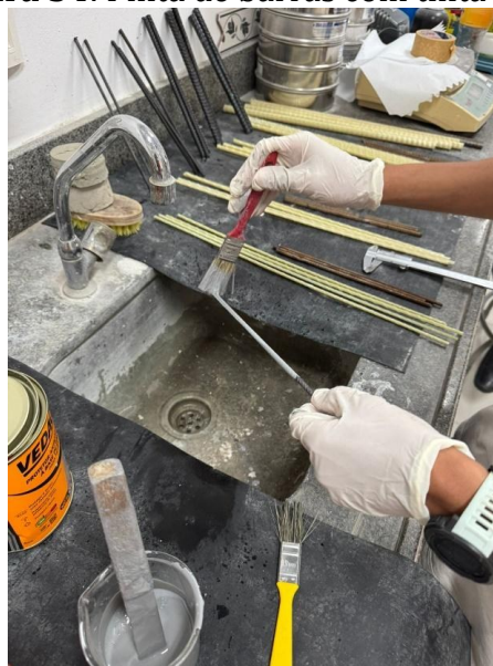
Figura 34: Pinta de barras com tinta epóxi
