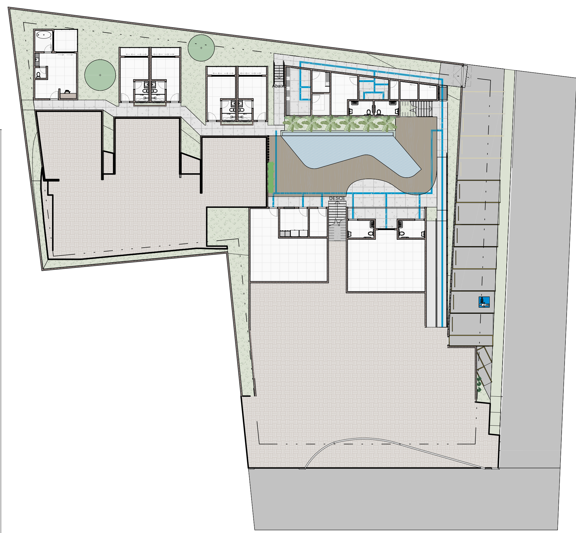
2 Planta de Rota Acessível Subsolo ESCALA: 1:250
