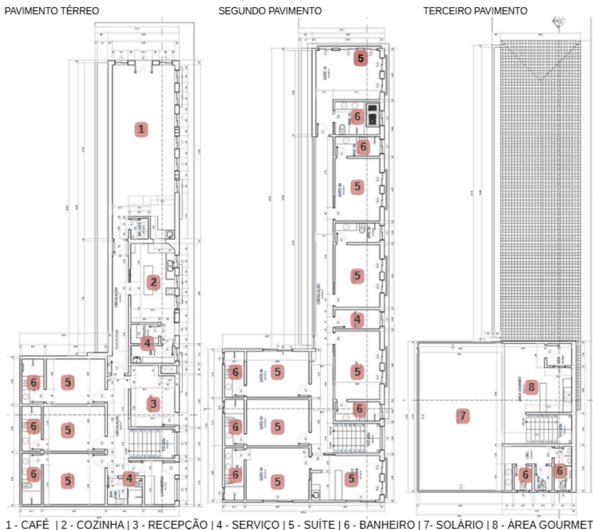
Figura 13 - Planta Baixa - Pavimentos - Pousada Du'Lírio
