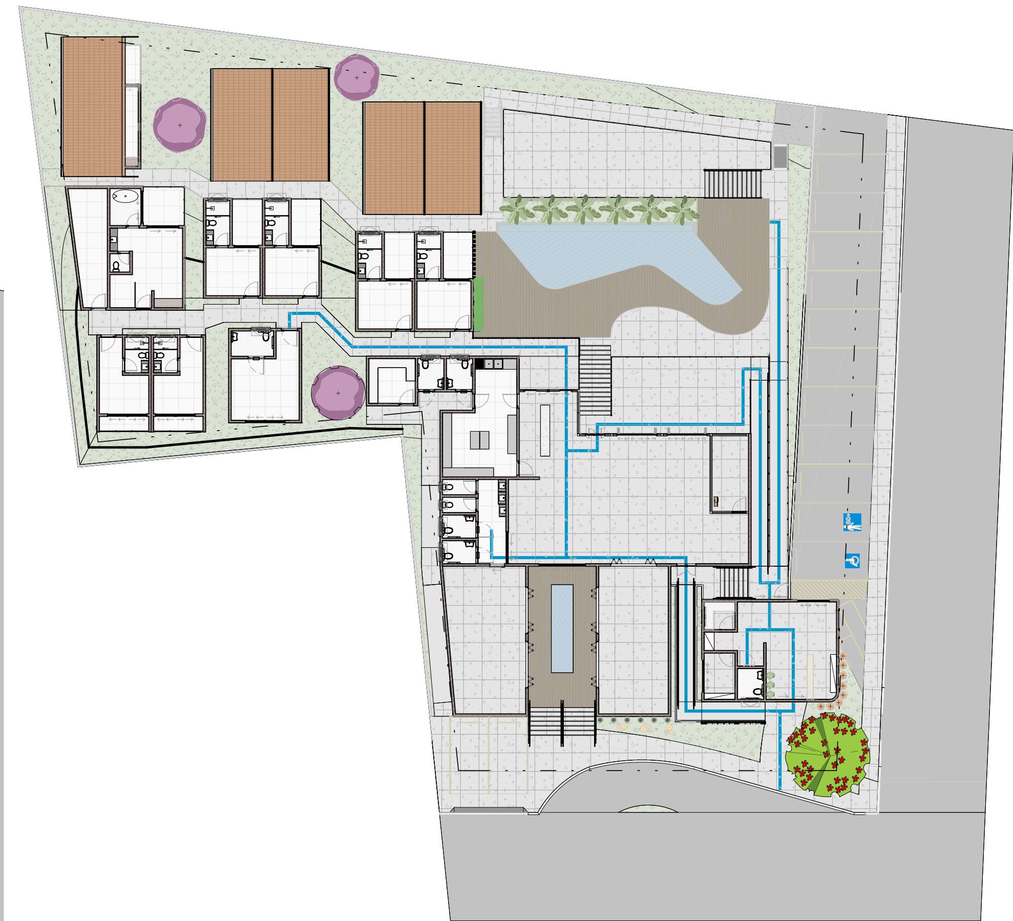
2 Planta de Rota Acessível Terreo ESCALA: 1 : 250
