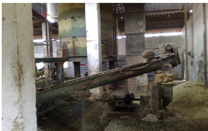
Figura 2. Transporte do caroço da estocagem até o triturado.
