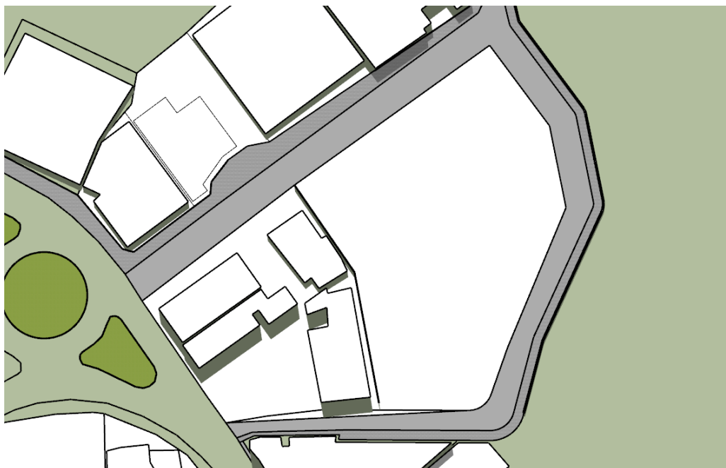
Figura 36 - Simulação do sombreamento das edificações vizinhas no terreno no equinócio de inverno.
