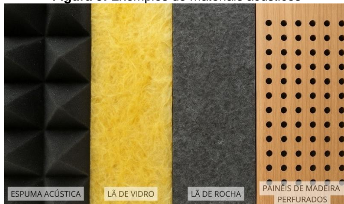
Figura 9: Exemplos de materiais acústicos
