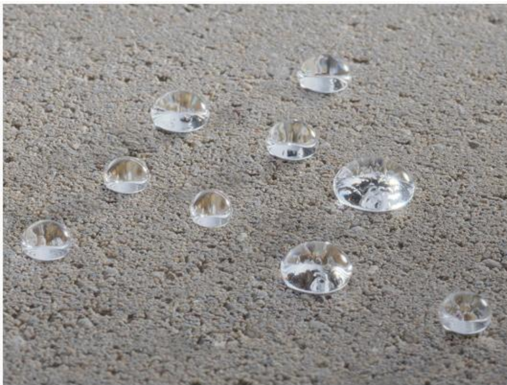
Figura 9 - Efeito de repelência à água em superfície tratada com aditivo hidrófugo.
