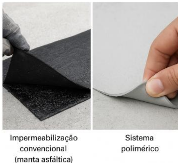
Figura 17 - Comparativo entre impermeabilização convencional (manta asfáltica) e sistema polimérico.
