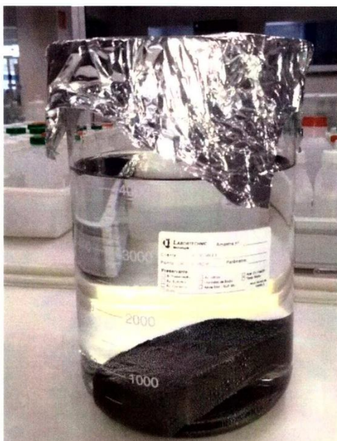
Figura 2. Corpo de prova BS-CRYL/IT durante os ensaios descritos na ABNT NBR 12.170, itens 3.2.1 e 3.3.2.
