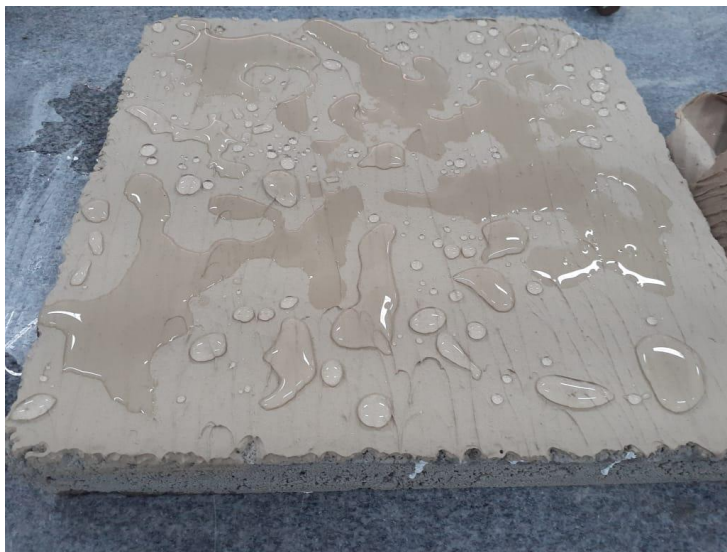
Figura 31 - Teste de estanqueidade em placa de concreto.
