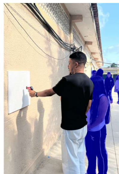
Figura 54 - Sensores para medição da temperatura superficial.
