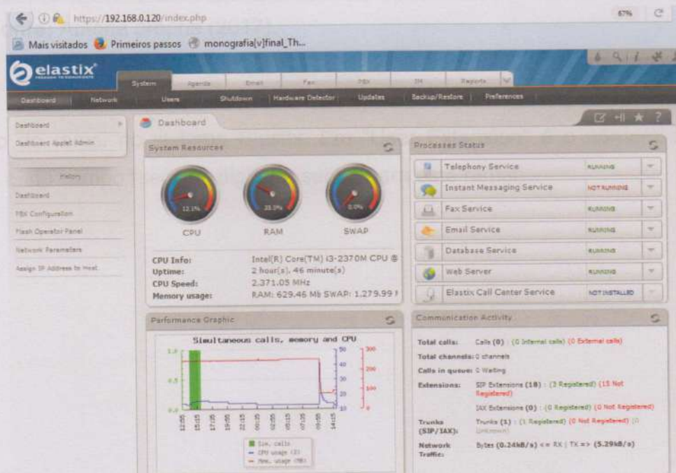
Figura 78 – Painel de Controle do Elastix
