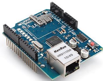
Figura 2 – Placa Ethernet Shield W5100 usada neste projeto.
