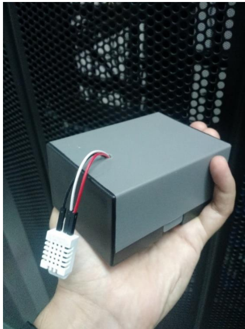
Figura 13 – Projeto finalizado em case plástico com o sensor do lado externo da caixa
