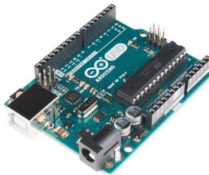
Figura 1 – Placa Arduino Uno usada neste projeto
