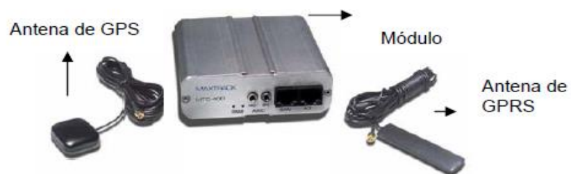
Figura 2: Ilustração dos equipamentos usados para recepção e transmissão dos dados
