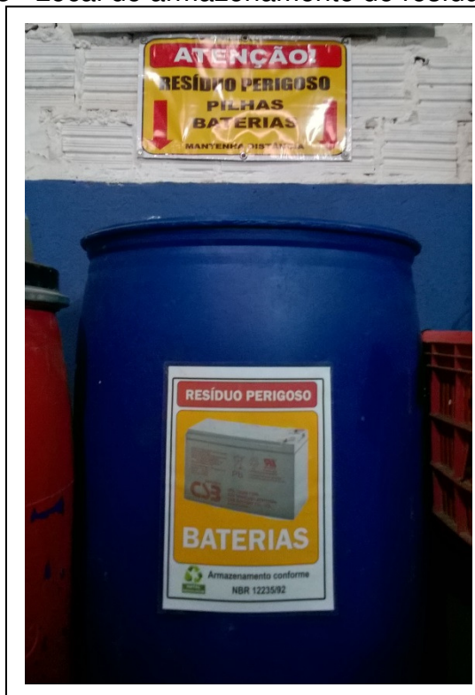
Figura 8 –Local de armazenamento de resíduos classe I
