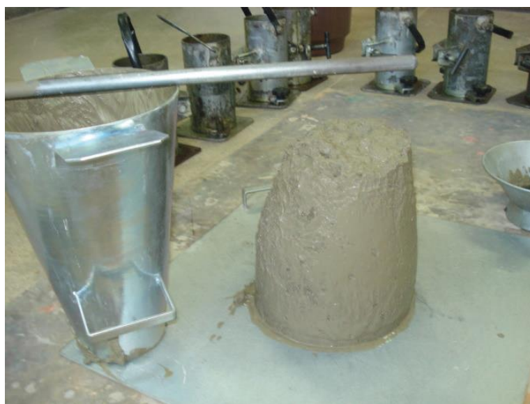
Figura 28: Ensaio de Abatimento de tronco de cone (Slump-Test)
