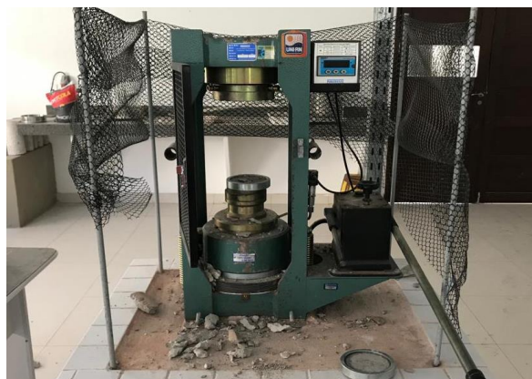
Figura 29 - Prensa utilizada no ensaio no laboratório do UNI-RN.
