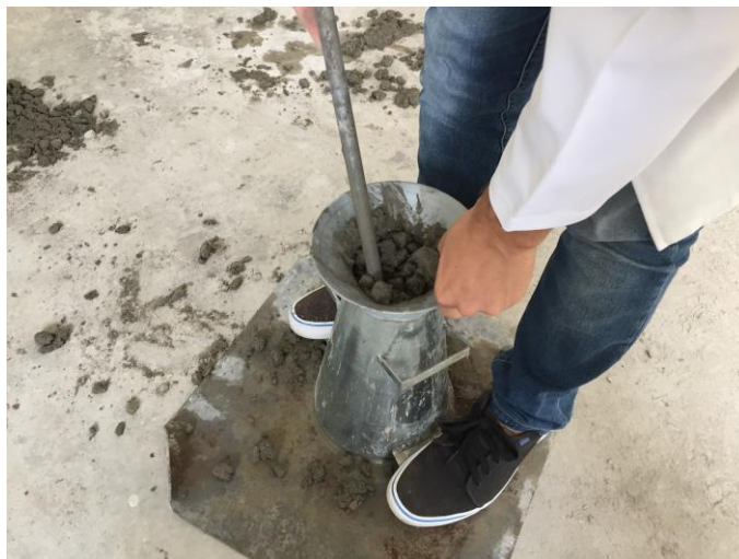
Figura 19 - Execução do ensaio de abatimento
