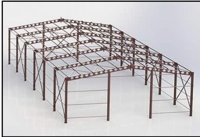
Figura 13 - Modelo de estrutura metálica
