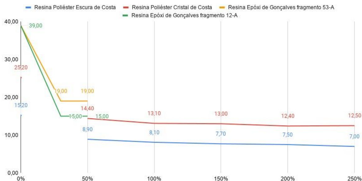
Figura 26 – Gráfico da variação da resistência média à tração EM MPA (eixo Y) dos ensaios de Costa e Gonçalves em função da concentração de resíduos de mármore e granitos (eixo X)
