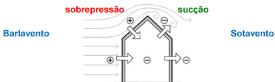
Figura 10 – Representação das ações do vento na cobertura
