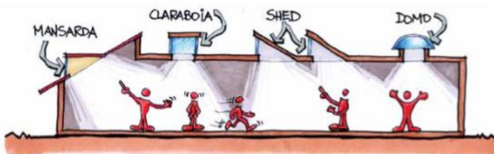
Figura 12- Tipos de iluminação zenital.
