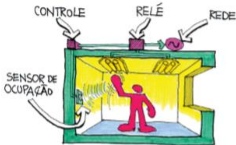
Figura 15- Sensores de presença.
