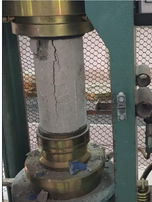
Figura 41 - Tipo de ruptura, classificada com Tipo E
