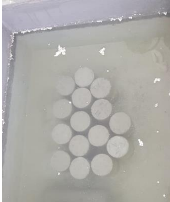
Figura 39 - CPs em tanque para cura e análise da absorção de água
