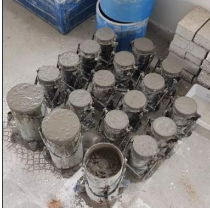
Figura 37 - Confeção dos corpos de prova
