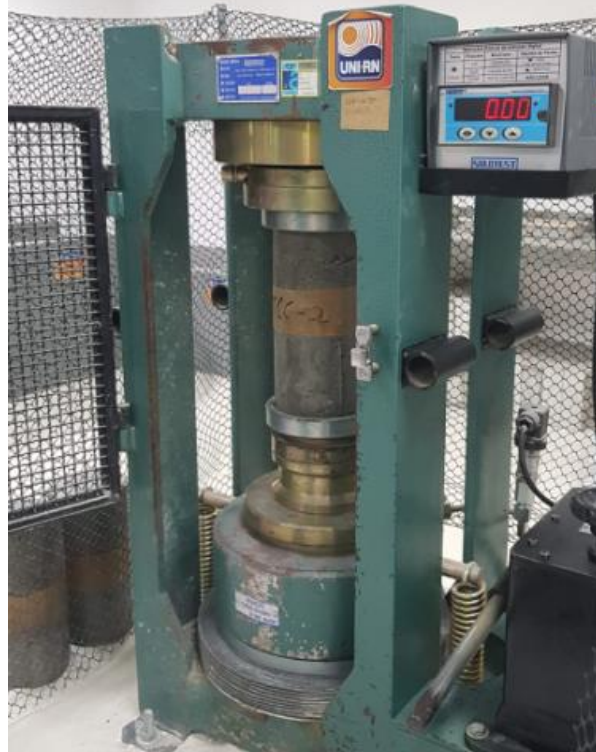
Figura 40 - Posicionamento de CP na prensa
