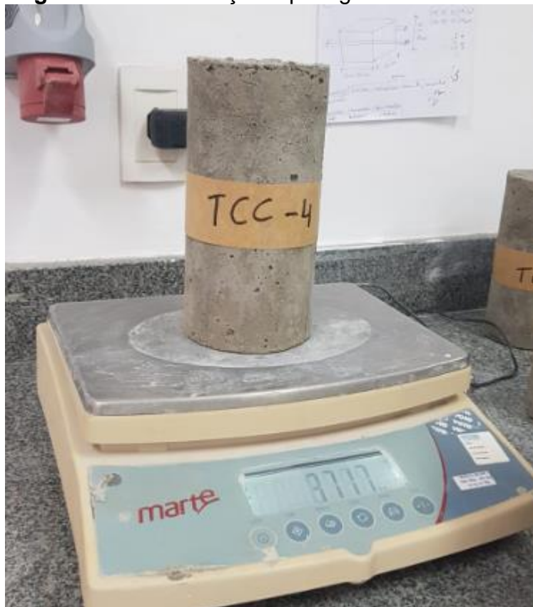
Figura 38 - Identificação e pesagem de CPs secos
