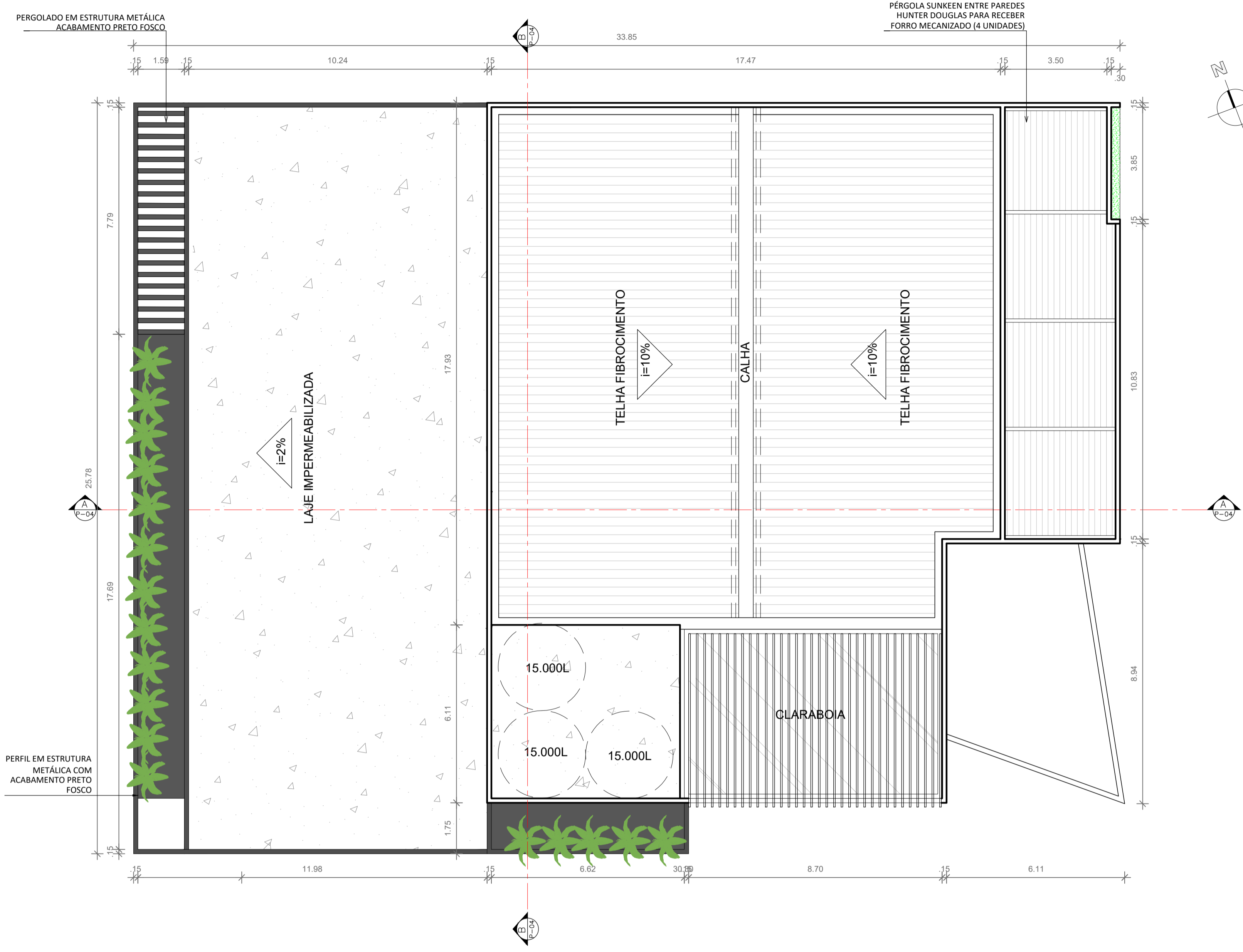
Planta de Cobertura ESCALA.....1/100
