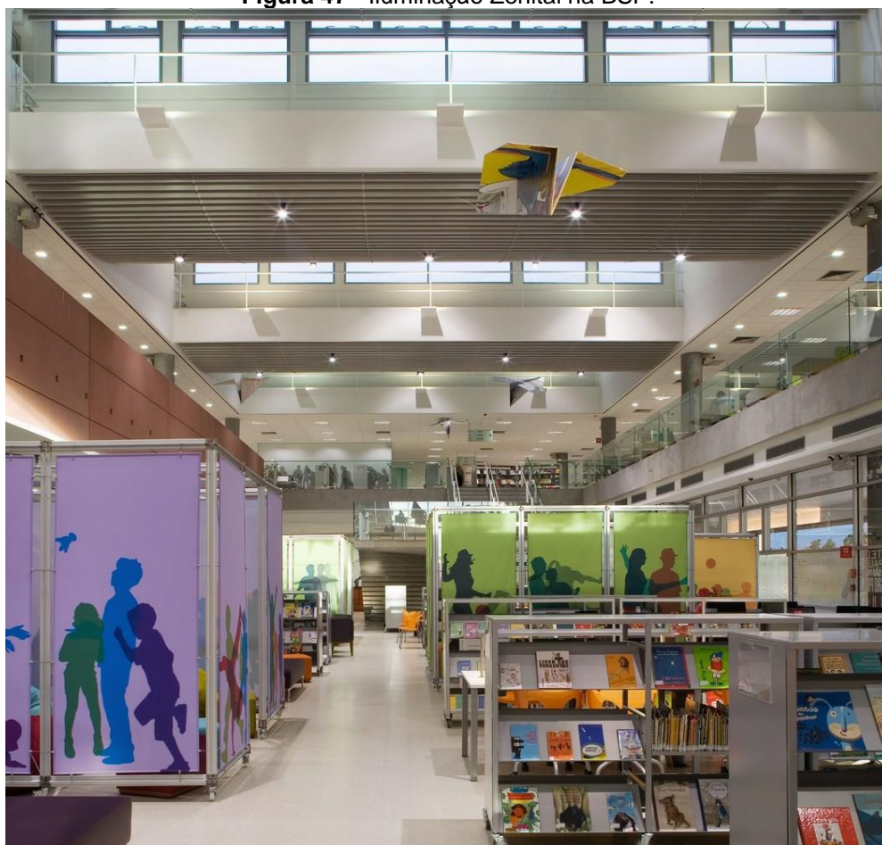
Figura 47 - Iluminação Zenital na BSP.
