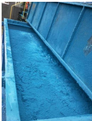
Figura 22: Processo de reciclagem de tintas de vasilhames de gás em tanque
