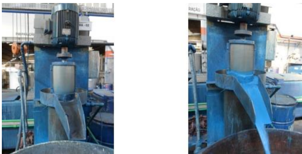
Figura 25: Processo de reciclagem de tintas de vasilhames de gás
