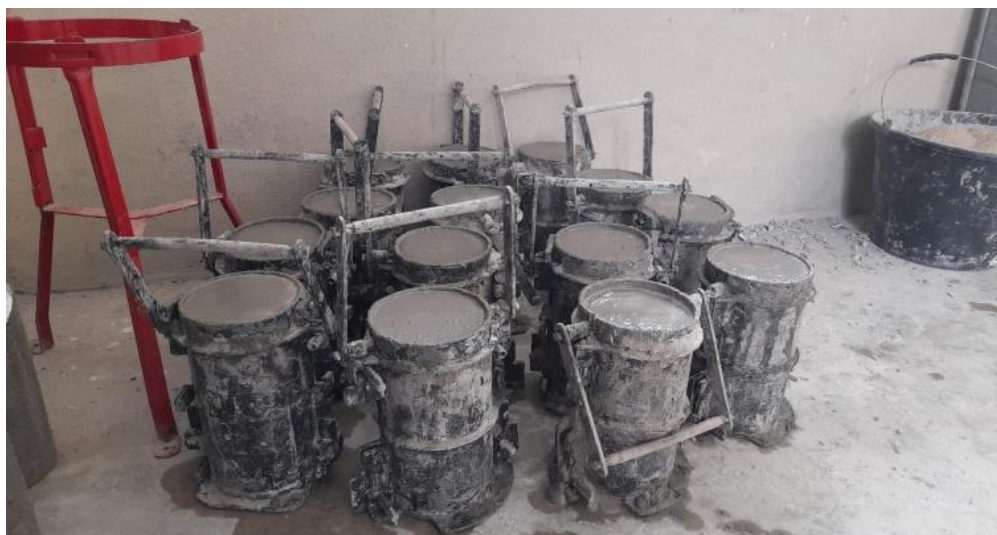
Figura 7: Corpos de prova preparados em moldes plásticos
