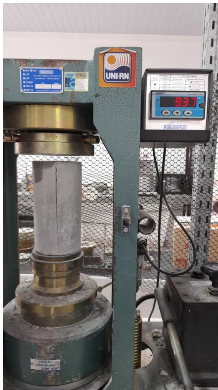
Figura 11: Ensaio de Compressão Prensa Hidráulica
