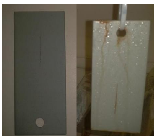
Figura 20 – Corpos de prova em aço comum pintados com tinta reciclada antes e depois do teste de corrosão em névoa salina.
