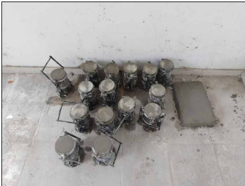
Figura 38 – Argamassa nos moldes
