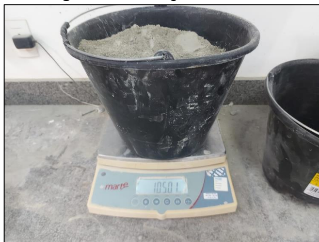
Figura 31 – Pesagem do cimento
