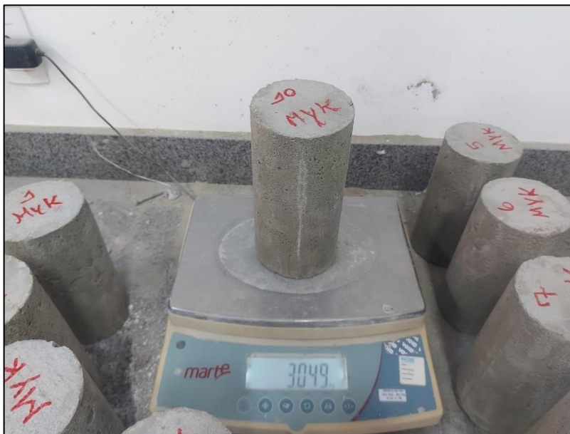
Figura 40 – Pesagem dos corpos de prova seco
