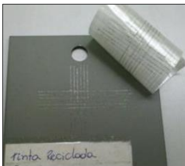
Figura 21 – Corpo de prova em aço comum pintado com tinta reciclada após o teste de aderência
