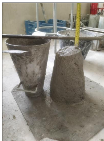
FIGURA 11: Ensaio de slump test realizado para o concreto em estudo
