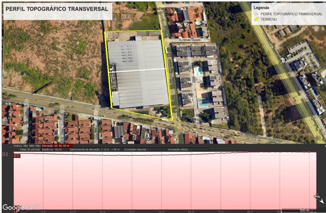
Figura 30 - Perfil topográfico transversal.
