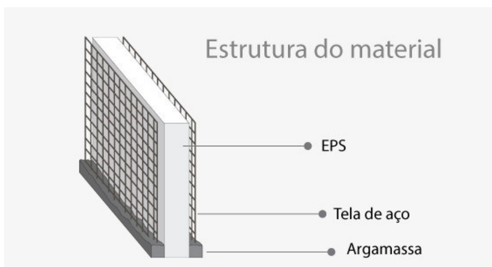
Figura 6: Painéis sanduíche com alma de EPS.
