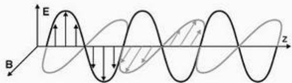
Figura 9.18 OEM propagando-se na direção +z . Os vetores campo elétrico ( \mathbf{E} ) e magnético ( \mathbf{B} ) são mutuamente perpendiculares.
