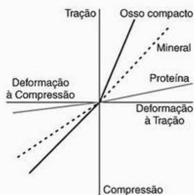
Figura 3.28 Relação linear entre tensão e deformação para um osso compacto e seus componentes mineral e protéico.
