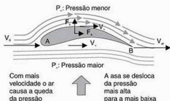
Figura 4.10 Devido a sua forma geométrica, quando a asa adquire mais velocidade, o ar causa uma queda de pressão.
