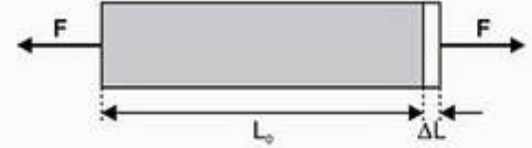
Figura 3.24 Corpo de constante elástica \kappa experimenta um esforço F , que produz uma deformação \Delta L .
