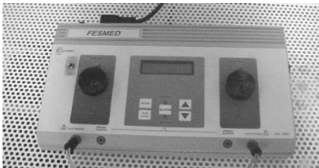
Fig. 3.1 — Aparelho gerador de correntes usado na avaliação da capacidade muscular de resposta matara à eletroterapia FES.
