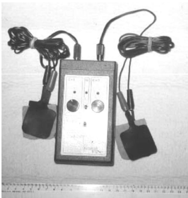
Fig. 5.12 — Aparelho gerador de trens de pulso individualizado às características do paciente, para uso domiciliar — modelo KC 304.
