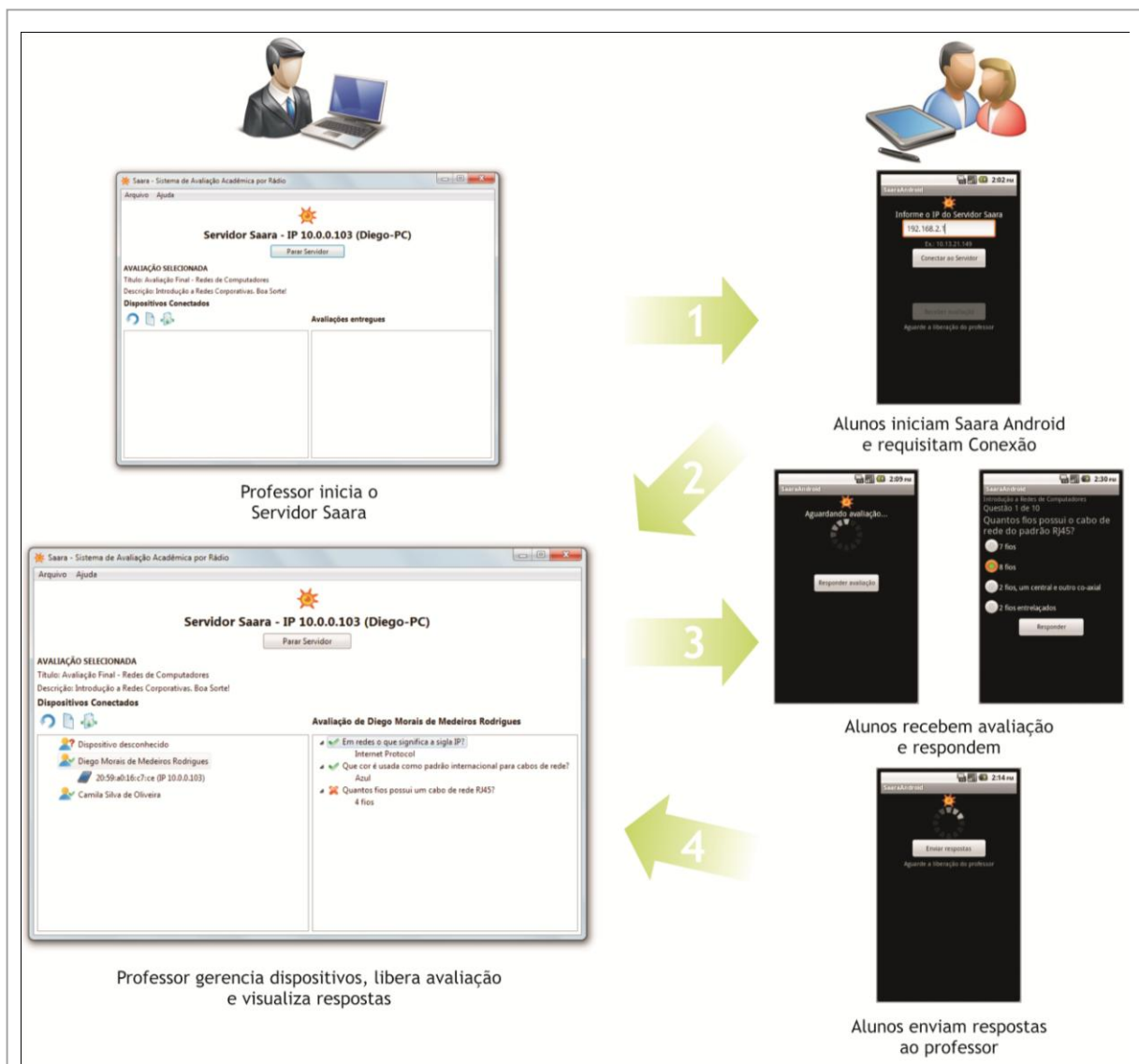
Figura 30. Diagrama das atividades de interação entre as aplicações Desktop e Android.
