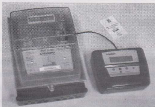
Figura 2 – Medidor, Unidade Split e cartão
