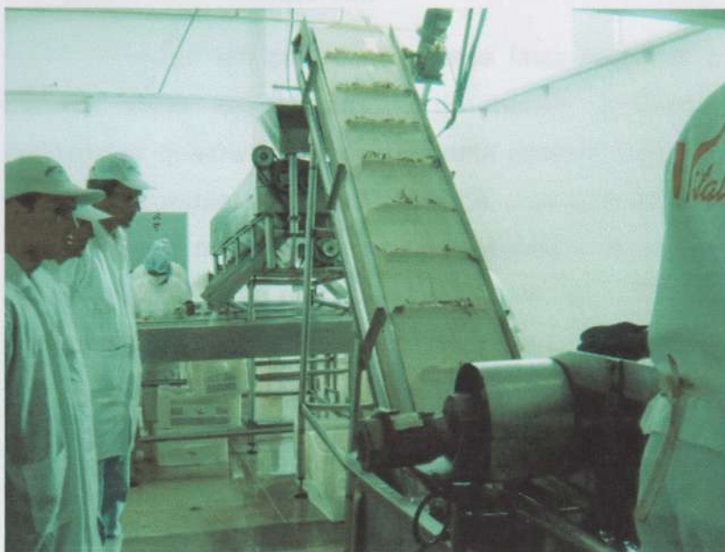
Figura 8: Esteira que leva o camarão para uma classificação mecânica Fonte:Ministério da Agricultura, Pecuária e Abastecimento, 2005
