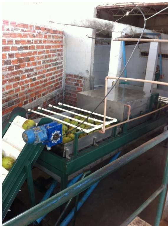
Figura 2. Lavador automático de cocos com 3 estágios
