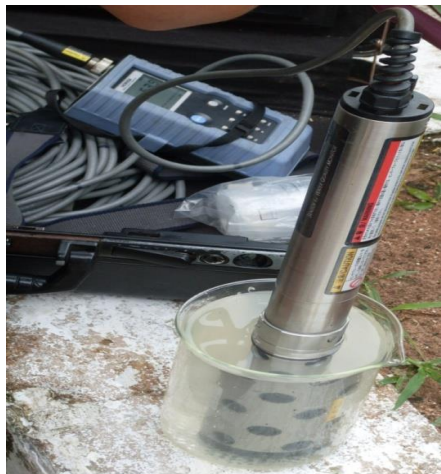
Figura 07: quantificação físico-química através do medidor de multiparâmetros HORIBA.
