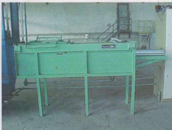
Figura 12 – Câmara de alimentação.
