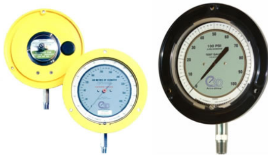
Figura 7: Profundímetros - Tubo Bourbon tipo helicoidal
