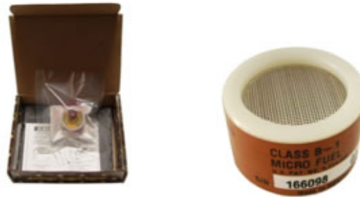
Figura 4 - Células de Oxigênio - Transdutor eletroquímico para sensoriamento de oxigênio.
