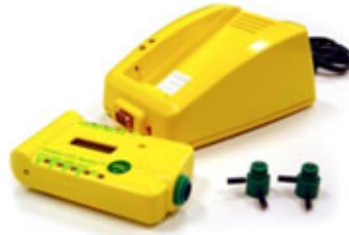
Figura 6 - Monitor portátil de dióxido de carbono
