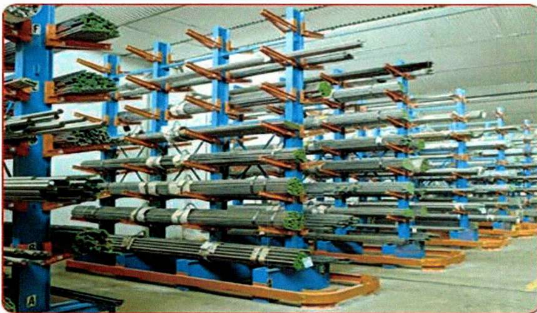
Figura 10: Estrutura de Cantilever Fonte: IMAM
