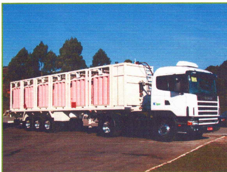
Figura 4 - O GNC sendo transportado pelo sistema NEOGÁS Fonte: Ellos Gás e Tecnologia do Brasil (2005).
