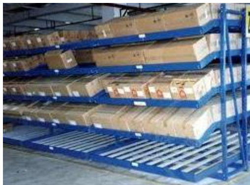
Figura 10: Sistema Flow Rack
