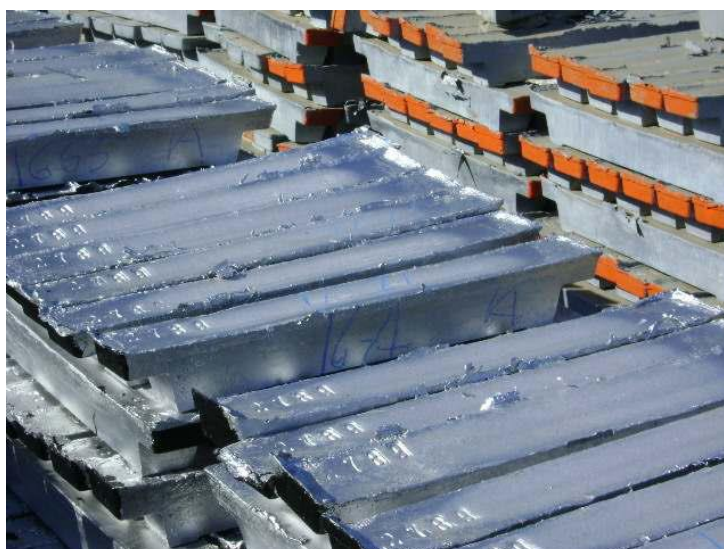
Figura 11: Liga de chumbo reciclado, pronto para reutilização Fonte: Tudor MG
