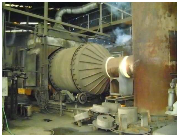
Forno rotativo de alimentação e queimador na dianteira
