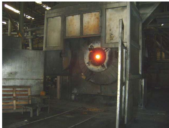
Forno rotativo com abastecimento dianteiro e queimador traseiro
