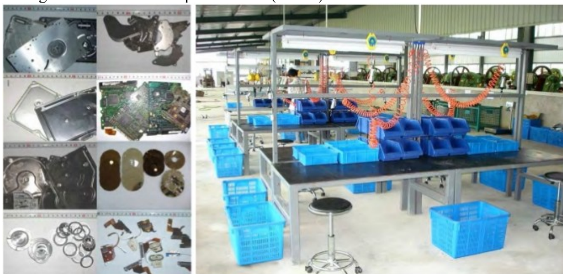
Figura 2 - Disco rígido desmontado e seus componentes separados (esquerda) e mesa de desmontagem com ferramentas pneumáticas (direita)
