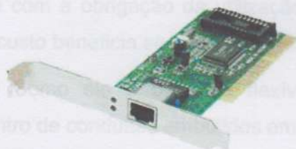
Figura 13 – Placa de rede para cabo de par traçado
