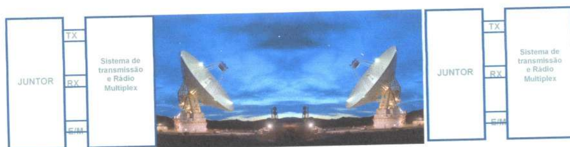
Figura 12: Sinalização E&M Pulsada e E&M contínua Fonte: Dados da pesquisa, (2008)
