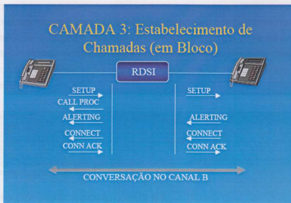
Figura 22: Chamada ISDN em bloco Fonte: Internet - Apostila UFC/IEL/INATEL (2008)
