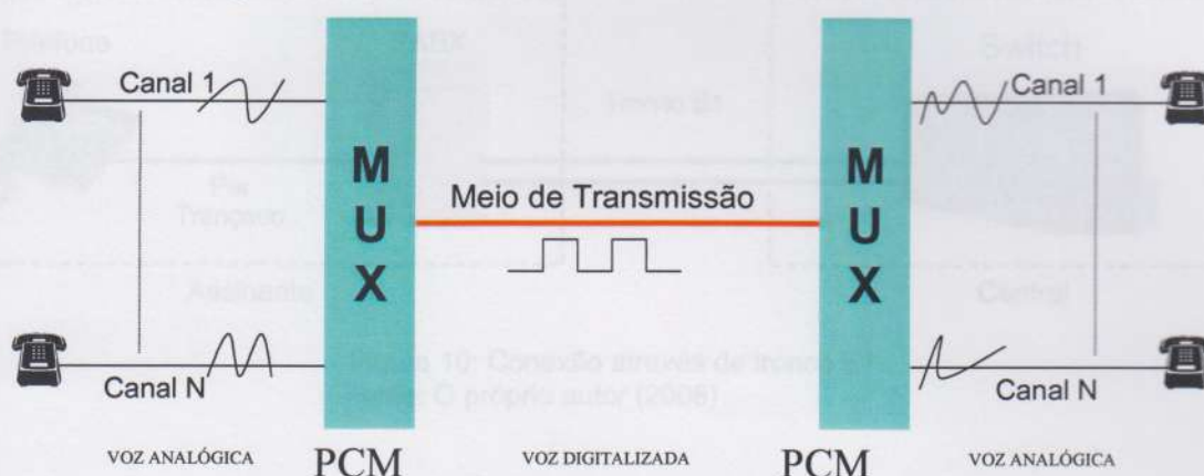
Figura 9: Multiplexação de sinais Fonte: Apostila EMBRATEL (2003)
