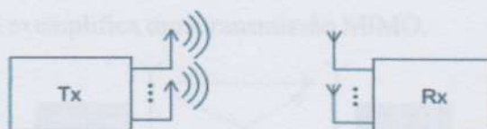
Figura 3.14: Modelo de antenas MIMO
