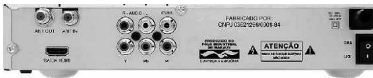
Figura 11: Vista traseira de um Set-Top-Box
