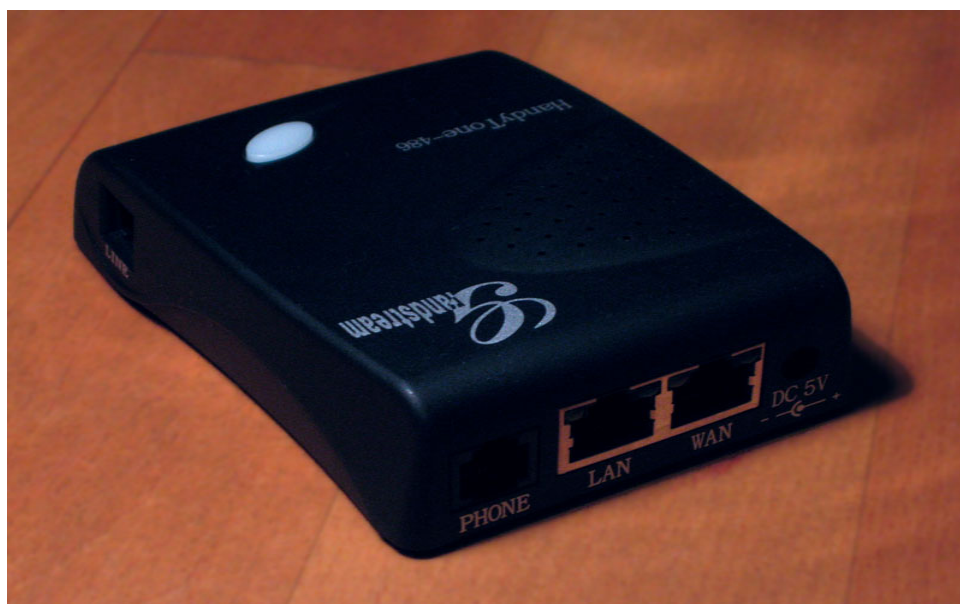
Figura 9: Exemplo de ATA (Adaptador de Terminal Analógico).
