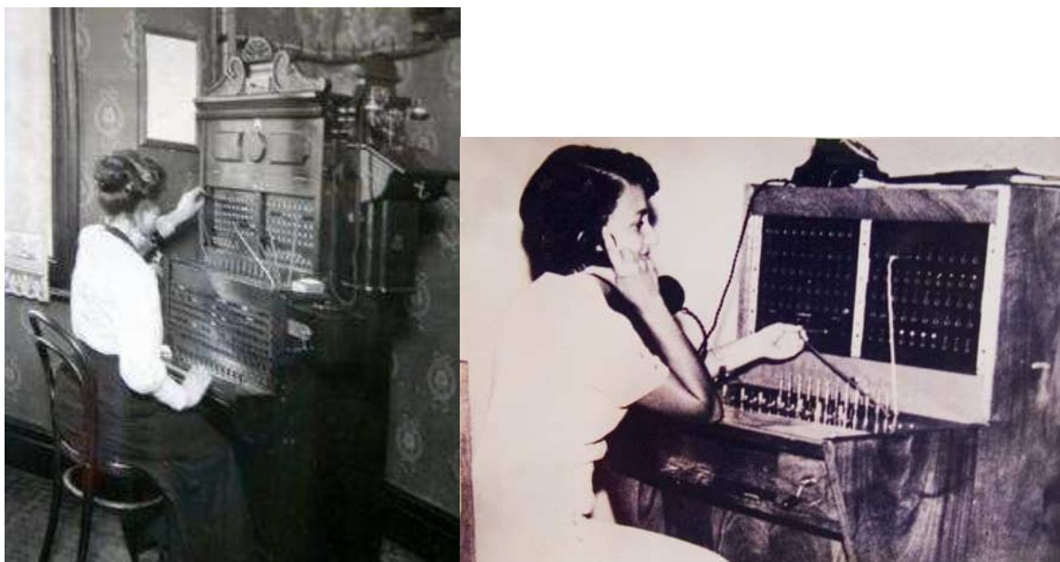
Figura 2 – Antiga central telefônica utilizando chaveamento físico manual
