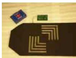
Figura 4: SmartPad - Um Wireless, Stickerless EKG do sistema [Cimit]
