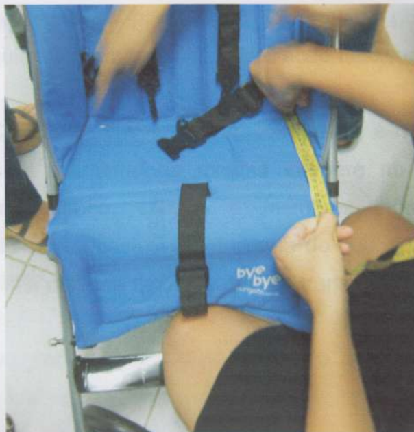
Fig. 13— Medição da profundidade do assento do carrinho de bebê.
