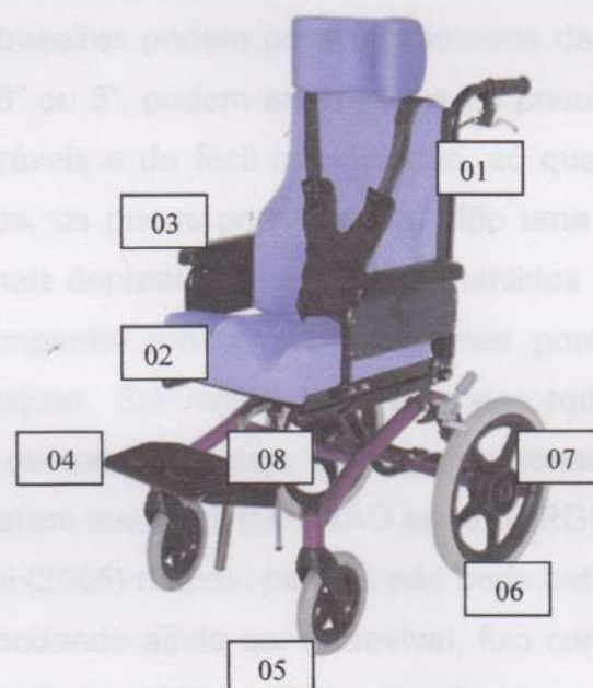
Fig. 2 – Cadeira de rodas especial: encosto (01), assento (02), apoio de braços (03), apoio de pés (04), rodas dianteiras (05), rodas traseiras (06), aro propulsor (07), estrutura (08).
