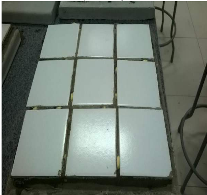
Figura 31 Placas cerâmicas assentadas para realização do ensaio do Pull-Off
