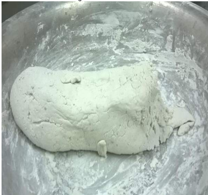
Figura 32 Textura e consistência da argamassa colante industrial ACIII-E do fabricante "B"
