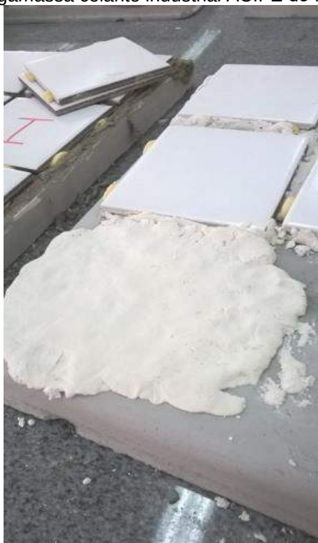
Figura 33 Assentamento argamassa colante industrial ACII-E do fabricante “B”
