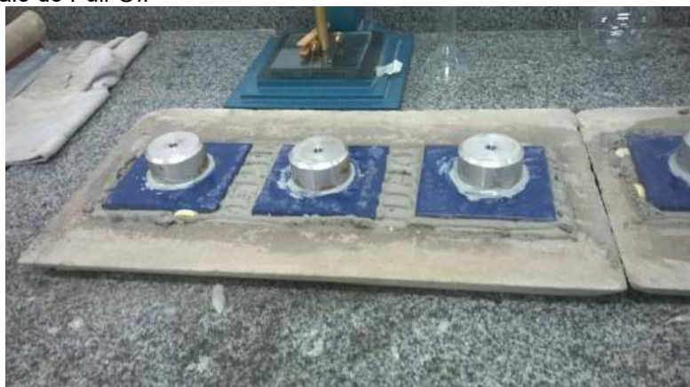
Figura 17 Preparação dos corpos de prova da argamassa industrial colante ACI do fabricante "A" para o ensaio do Pull-Off
