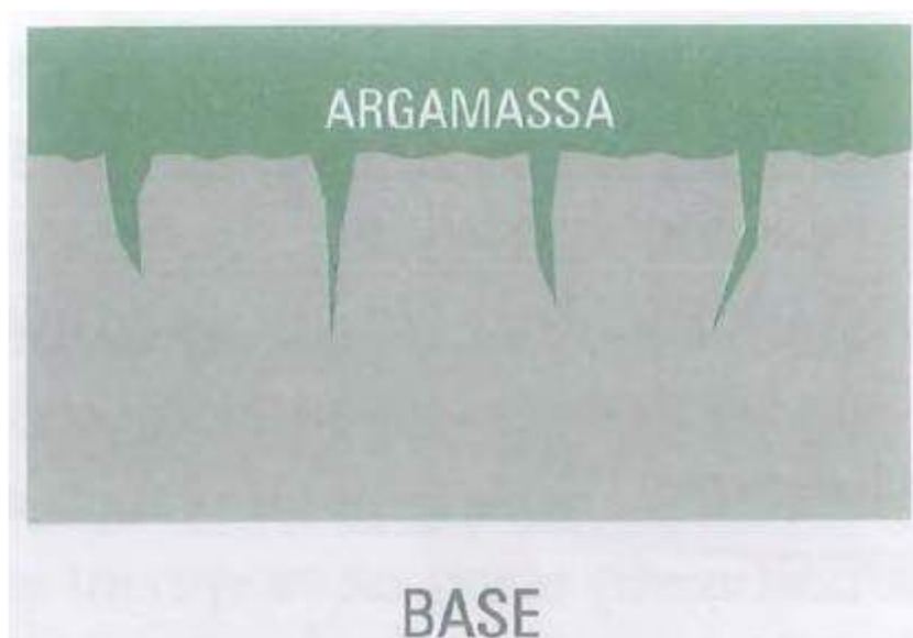
Figura 2 Aderência da argamassa na base.
