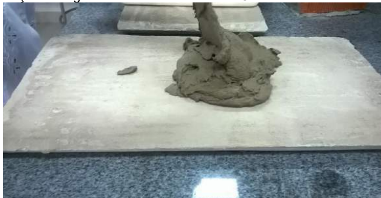
Figura 14 Colocação da argamassa colante industrial ACI do fabricante "A" no substrato
