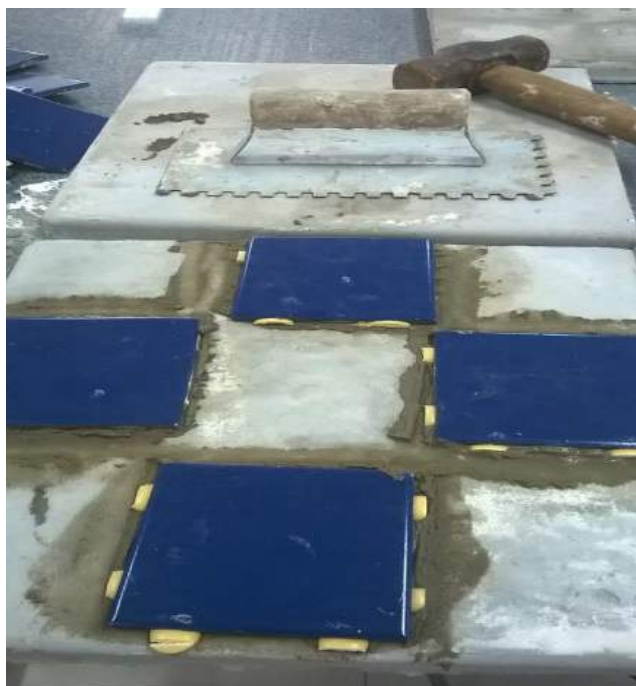
Figura 23 Corpos de prova da argamassa colante industrial ACIII-E do fabricante “A”
