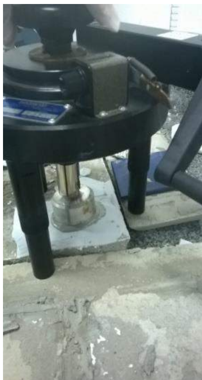
Figura 27 Ensaio do Pull-Off no corpo de prova da argamassa colante industrial ACI do fabricante “B”
