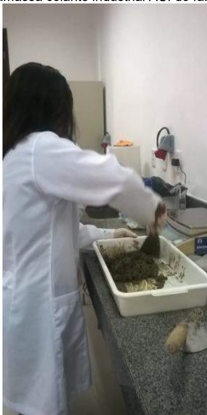
Figura 12 Preparação da argamassa colante industrial ACI do fabricante "A"
