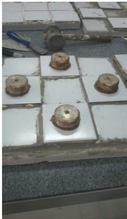
Figura 36 Preparação dos corpos de prova da argamassa colante industrial piso sobre piso para o ensaio do Pull-Off
