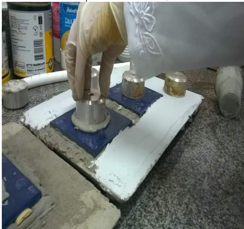
Figura 26 Preparação dos corpos de prova da argamassa colante industrial ACI do fabricante “B” para o ensaio de Pull-Off
