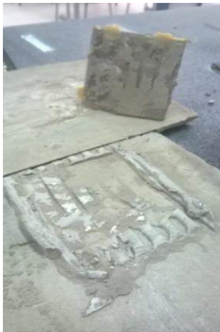
Figura 19 Após arrancamento do Corpo de prova da argamassa industrial colante ACI do fabricante "A"
