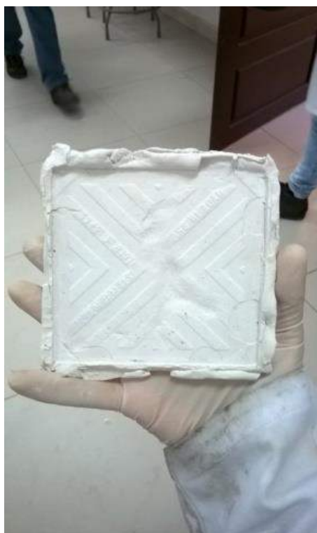
Figura 34 Argamassa colante industrial ACII-E do fabricante “B” após a realização do ensaio do Pull-Off
