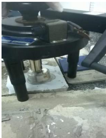
Figura 18 Ensaio do Pull-Off no corpo de prova da argamassa industrial colante ACI do fabricante "A"
