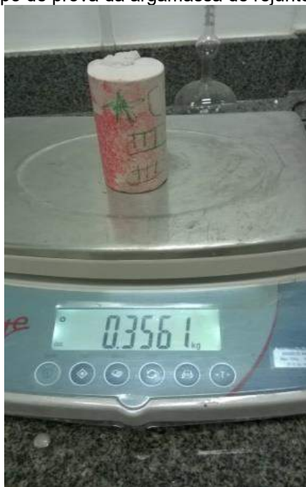
Figura 42 Peso saturado corpo de prova da argamassa de rejunte do fabricante “A”
