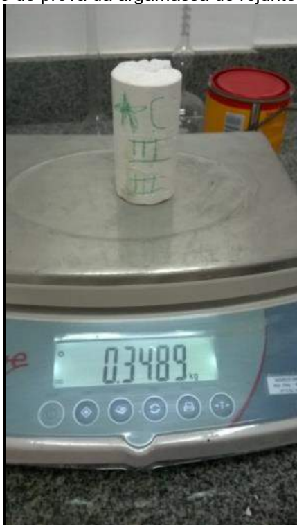
Figura 40 Peso seco do corpo de prova da argamassa de rejunte do fabricante “A”
