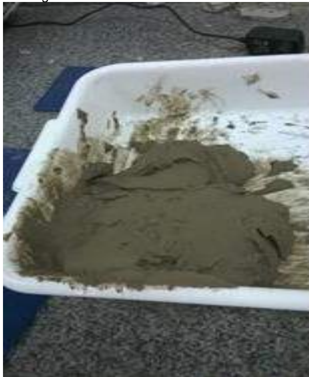
Figura 24 Preparação da argamassa colante industrial ACI do fabricante “B”
