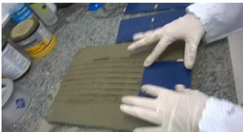
Figura 16 Assentamento da placa cerâmica 10x10 cm
