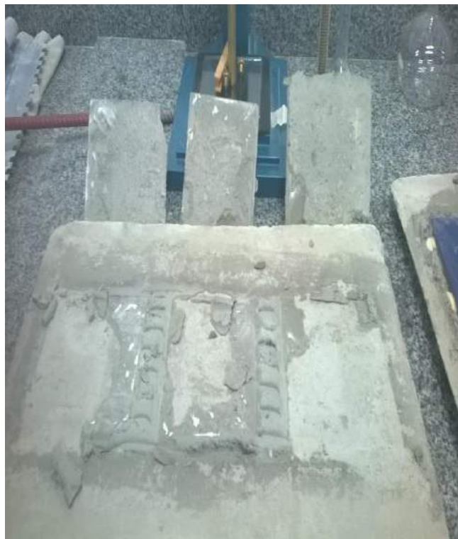
Figura 28 Após arrancamento do Corpo de prova da argamassa industrial colante ACI do fabricante "B"
