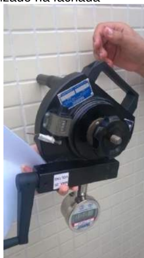
Figura 49 Ensaio de Pull Off sendo realizado na fachada
