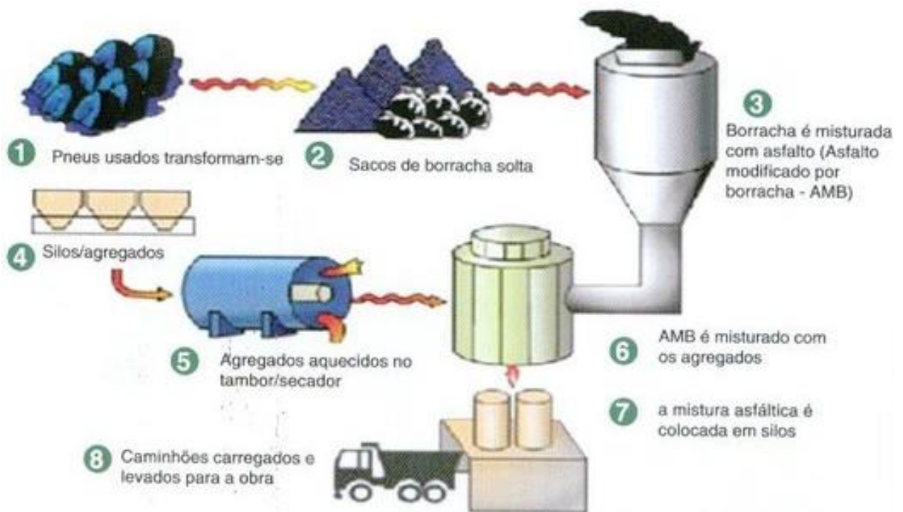
Figura 4 – Modelo Simplificado da Produção do Asfalto Borracha
